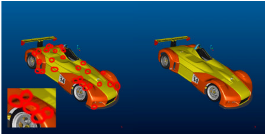
Figura 1. 4 bit di precisione subpixel (sinistra) a confronto con i 12 bit offerti dalla NVIDIA Quadro FX (destra)
