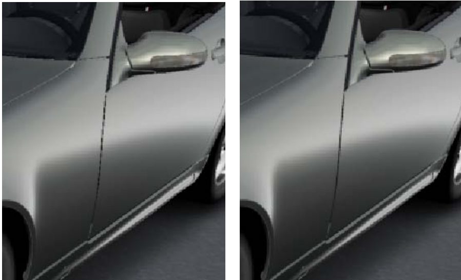
Figura 3. L'immagine a sinistra si avvale di un modello di multicampionamento tradizionale, mentre quella a destra ricorre a un modello di multicampionamento ruotato.
